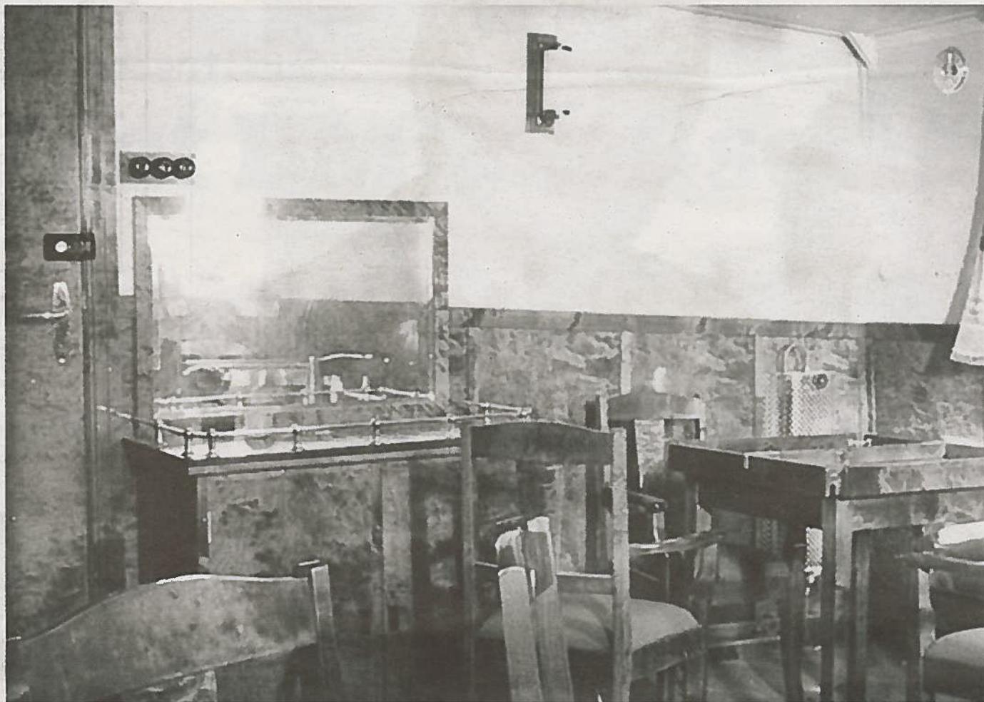
MATSAL: Passasjerenes spiserom MS «Thor I» bygget i 1938. Man kan se anretningsbordet på venstre side og slingrekanter på bordet.
